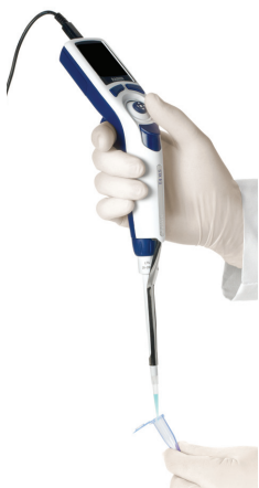
图 26: 连接到 E4-WPS 电源时操作 E4 XLS
